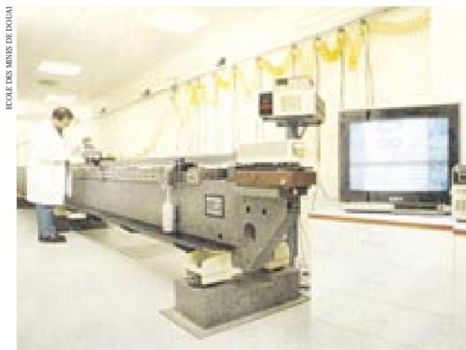
Le banc d'essai de Douai mesure aussi bien une cale de 10 cm qu'un ruban de 200 m.
