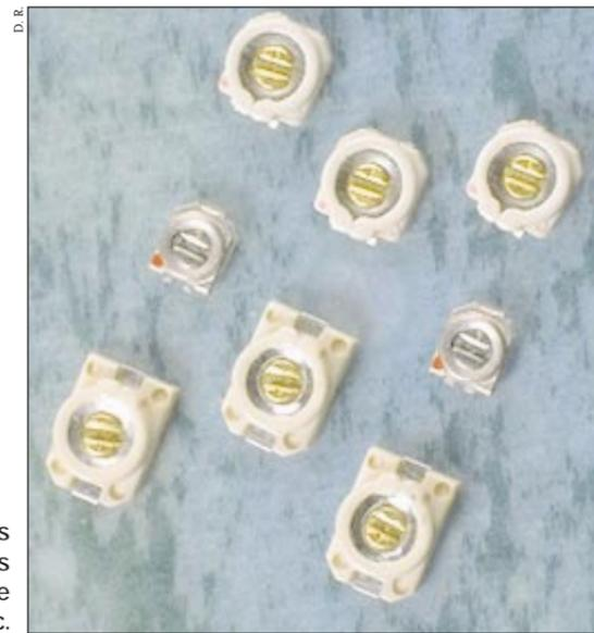
Condensateurs ajustables fabriqués sur le site de Pessac.
